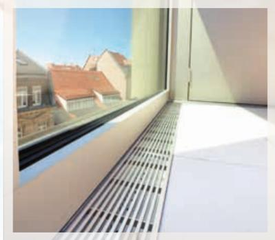
Die Rinnen mit den Einlaufbreiten von 100 mm, 160 mm und 260 mm sind dank ihrer Stelzlager von 115 mm auf 170 mm und von 165 mm auf 220 mm in der Höhe verstellbar. Hierdurch lassen sich die Rinnen ganz einfach an das jeweilig benötigte Bodenniveau anpassen, so dass die Roste einen barrierefreien Übergang von innen nach außen gewährleisten.
