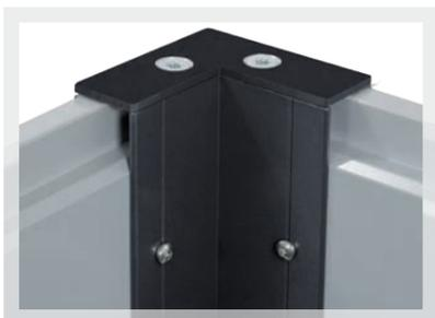
Mit selbstschneidenden Schrauben werden die Paneele an den Eckelementen von innen fixiert. Da die Befestigungsstellen somit verdeckt sind, können die Paneele auch im Nachhinein noch gelöst und gewendet werden.
