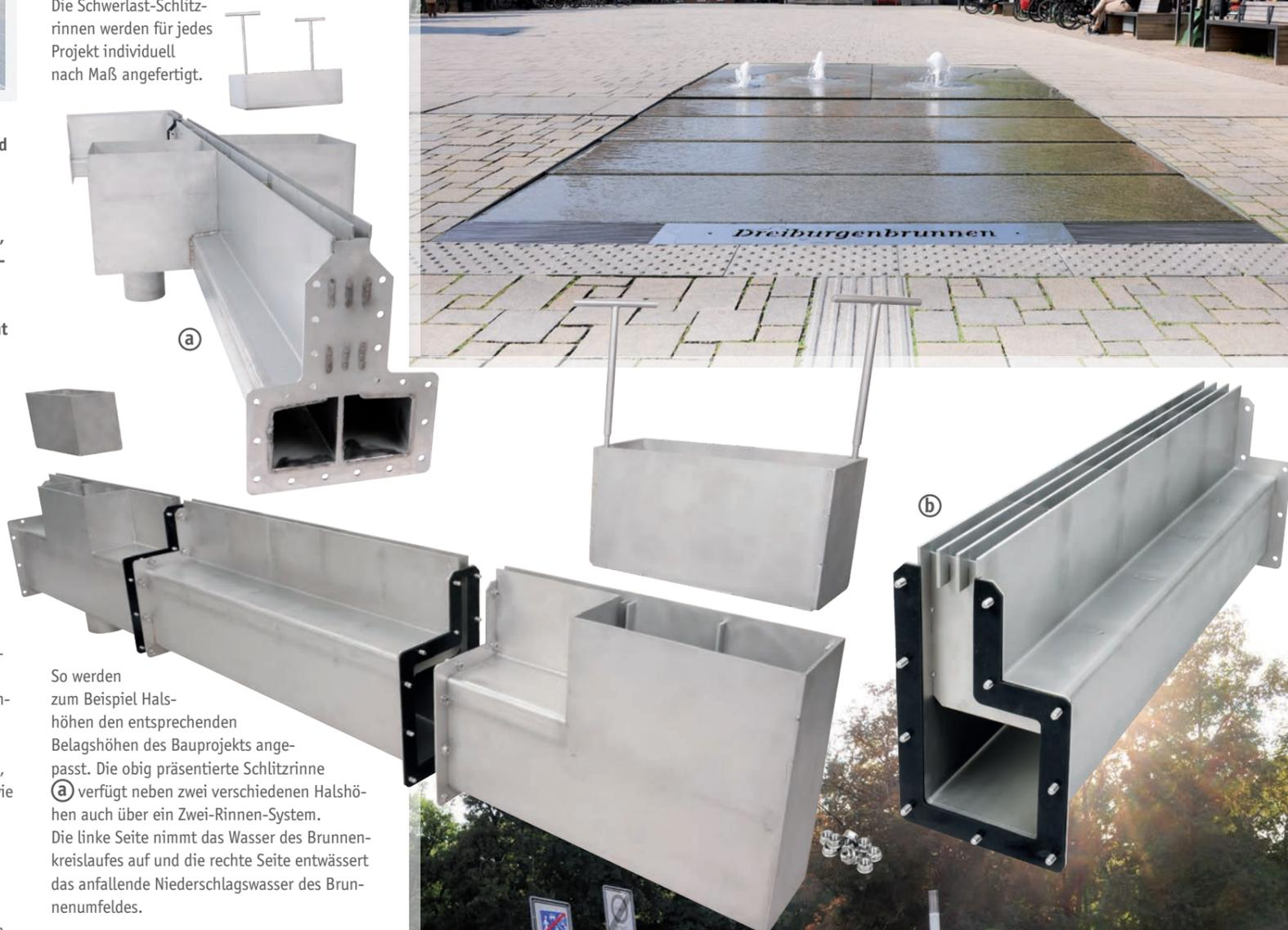
So werden zum Beispiel Halshöhen den entsprechenden Belagshöhen des Bauprojekts angepasst. Die obig präsentierte Schlitzrinne **a** verfügt neben zwei verschiedenen Halshöhen auch über ein Zwei-Rinnen-System. Die linke Seite nimmt das Wasser des Brunnenkreislaufes auf und die rechte Seite entwässert das anfallende Niederschlagswasser des Brunnenumfeldes.
