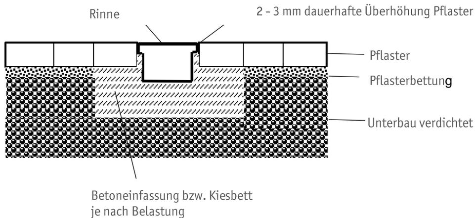
Die Rinne ist bei höherer Belastung in ein ausreichend dimensioniertes Betonfundament zu versetzen, wobei bei der begehbaren Variante auch ein Kiesbett ausreichend ist. Der Unterbau muss gut verdichtet werden, um spätere Setzungen zu vermeiden.
