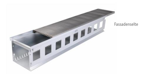
Die Fassadenrinne besteht aus einem Rinnenkörper und einem Rost. Auf der Fassadenseite befinden sich die Lüftungsöffnungen, die für die Durchlüftung des Wandanschlusses sorgen. Durch die Abkantung wird der Rinnenkörper auf Distanz zur Wand gehalten. Auf der fassadenabgewandten Seite sind die Langlöcher, 30 x 5 mm, für die Wasserabführung angeordnet.
