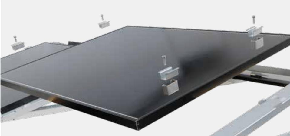
Die Modulklemmen fixieren die Module auf der Unterkonstruktion. Jedes Modul muss von 4 Modulklemmen gehalten werden werden.
