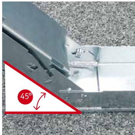
Zu beachten ist, dass die Haken, wie im Bild oben gezeigt, ineinandergreifen. Erst hierdurch entsteht eine belastbare Verbindung. Der so entstehende Kanal kann zur Verlegung der Kabel genutzt werden. Wichtig ist, dass die seitlichen Löcher frei bleiben (*Wasserabfluss*).
