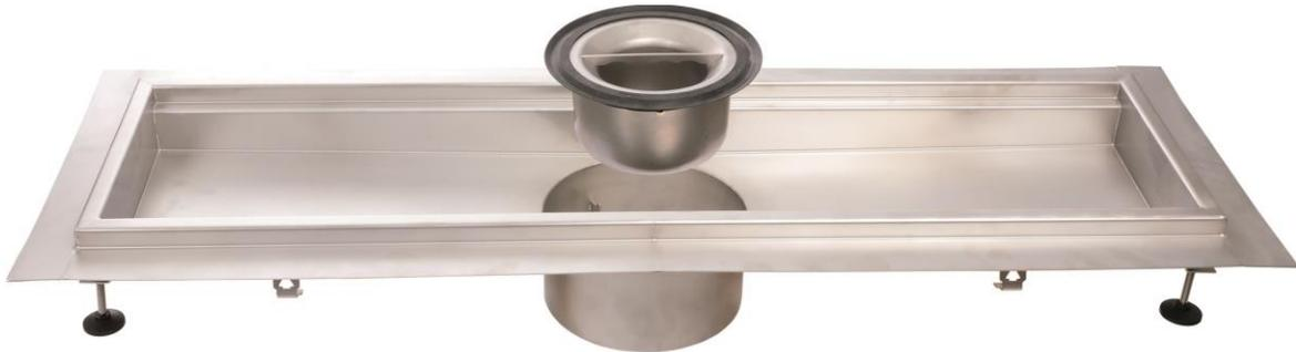
Das Rinnenunterteil ist mit vier höhenverstellbaren Stellfüßen versehen, mit denen die Rinne waagrecht ausgerichtet und für den Verguss mit Estrich vorbereitet wird. Dazu wird das Unterteil über dem Bodenablauf mit der Tauchglocke positioniert. Dabei ist es wichtig, darauf zu achten, dass die Abdichtungsbahn nicht beschädigt wird.
