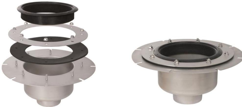
Der Bodenablauf wird auf die Rohbaubetondecke montiert. Dazu wird eine Kernbohrung (Durchmesser 250 mm) in die Decke hergestellt. Die Entwässerungsleitung, DN 100, wird von unten durchgesteckt.
