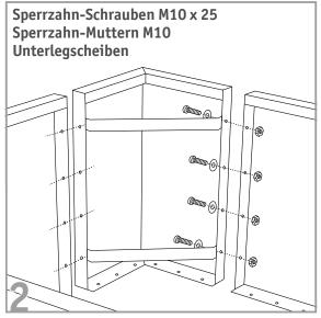
Module verschrauben: Verschrauben Sie die Module jeweils an allen Bohrungen der Flanschverbindungen miteinander. Im oberen und unteren Bereich der Ecken müssen zusätzlich Zugstreben angebracht werden.
