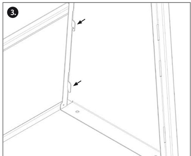
Unterstes Panel mit den Haken in die dafür vorgesehenen Schlitze an den Seitenwänden einhängen.
