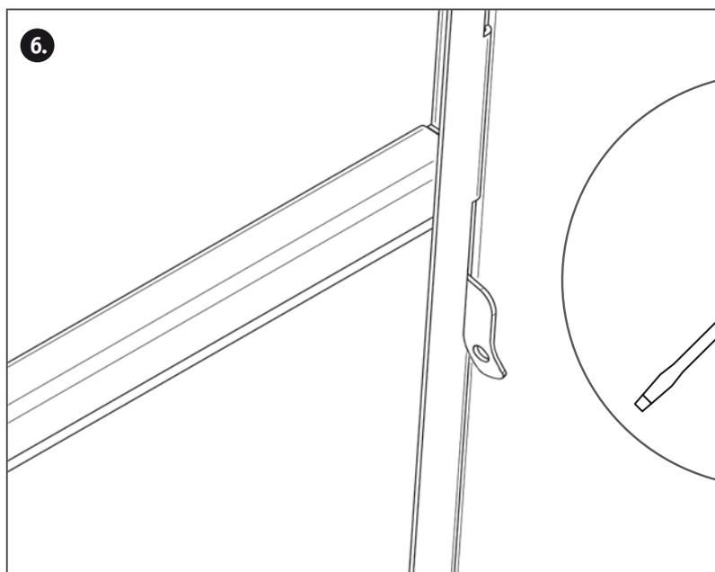
Als zusätzliche Entnahmesicherung können die oberen Laschen der Panels mit einem Schraubendreher verbogen werden.
