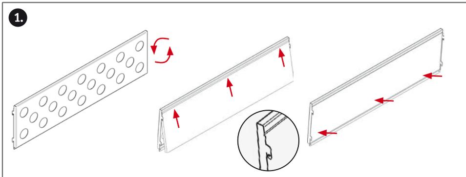
In die Panels können Styrodur-Platten eingeklippt werden.
