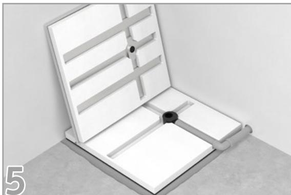
**5** Edelstahlwanne mit unterseitig aufgeklebtem XPS-Block einbringen und ...
