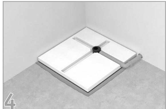
**4** Einsetzen und Anschluss des Siphons am Abflussrohr
