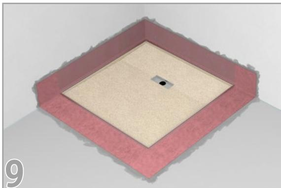
9 Dichtbänder entlang der Abkantungen ankleben und Übergang abdichten
