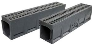
Die Neuheit des Metallwarenherstellers aus Polymerbeton vereint Rinnenkörper und Rost in einem monolithischen Bauteil. An den Rinnenstößen gewährleistet ein Nut-Feder-System mit integrierter Gummidichtung einen wasserdichten Übergang.
