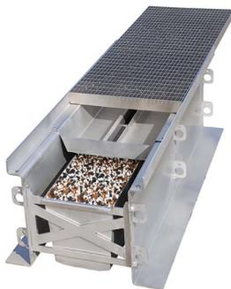
RichardBrink\_RigoMax\_05 Cette nouveauté dans la gamme Richard Brink abrite des inserts filtrants intégrés. Grâce à ses rebords, l'insert supérieur retient les saletés grossières, les débris provenant de l'usure des pneus et les microplastiques. La cartouche du bas est capable de filtrer les substances liées à l'eau.
