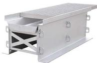
RichardBrink\_RigoMax\_04 Ces caniveaux gagnent encore en stabilité grâce à des entretoises intégrées et à des pattes d'ancrage à bétonner à la base des parois extérieures.
