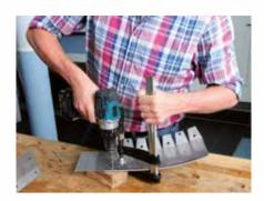
Die Verbinderbleche sind durch fünf Perforationslinien unterteilt und lassen sich dank dieser Sollbiegestellen jeder Rundung anpas-
