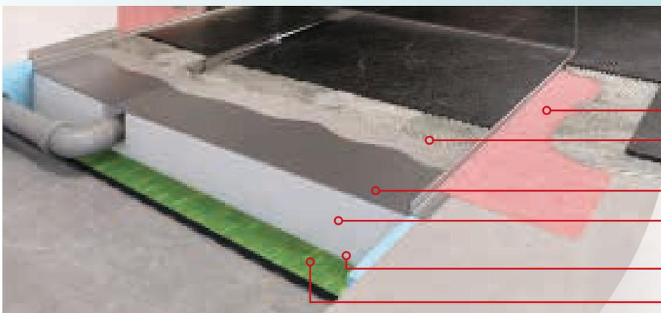
Umlaufende Dichtmanschetten (immer beiliegend, auf Wunsch vormontiert)
